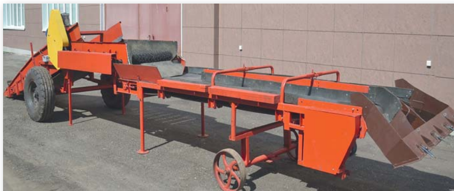
Универсальная сортировка с приемным бункером и затаривающим блоком
