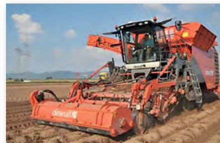
Рис. 3. Самоходный четырехрядный картофелеуборочный комбайн Kwatro
