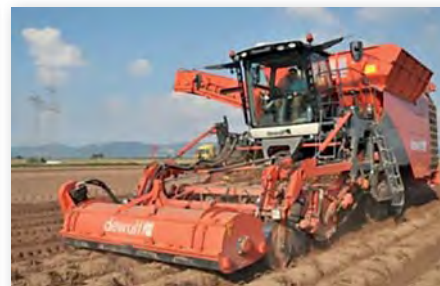
Рис. 3. Самоходный четырехрядный картофелеуборочный комбайн Kwatro
