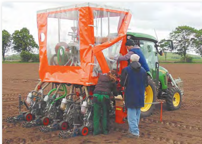
Специализированная селекционная сеялка для закладки сорто-опытов (Германия, г. Ганновер, 2013 год)
