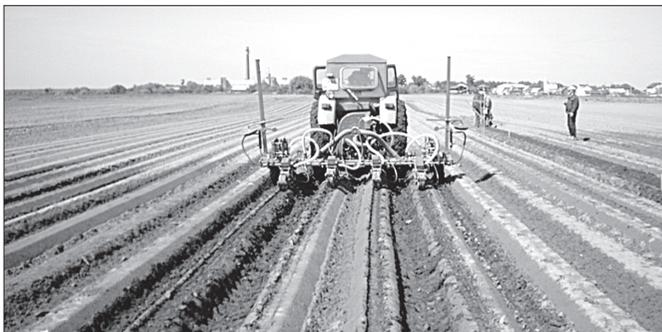
Рис. 1. Сеялка овощная точного высева СОНП-2,8
