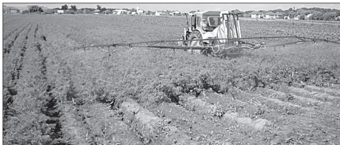
Рис. 8. Малообъемный опрыскиватель для внесения пестицидов и внекорневых подкормок "Заря" -600-12-ОНГ-10
