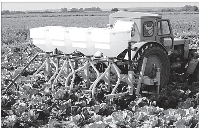
Рис. 3. Культиватор для ленточного внесения жидких удобрений и пестицидов КЛ-2,8
