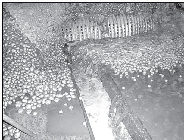
**Рис. 1. Смыв клубней из насыпи в канал гидравлической системы выгрузки**
