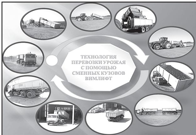
**Рис. 2. Схема технологии транспортировки картофеля с применением системы ВИМЛИФТ и сменных кузовов**
