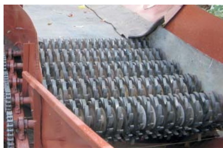
Рис. 2. Ротационный сепаратор, установленный в загрузчик ТЗК-30
