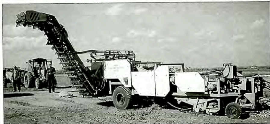
Рис. 12. Машина для уборки лука-репки КПЛ-1200
