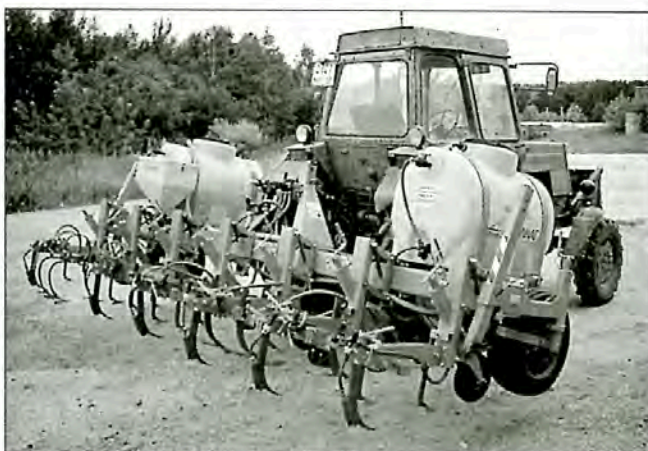
Рис. 5. Культиватор для ленточного внесения жидких удобрений и пестицидов
