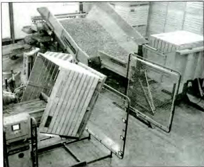
**Рис.4.** Наполнитель контейнеров серии АКВ и опорожнитель контейнеров серии АКЛ
