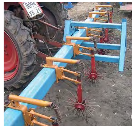
Рис. 3. Почвообрабатывающий адаптер к пропашным сеялкам, предложенный для разрушения почвенной корки в междурядье
