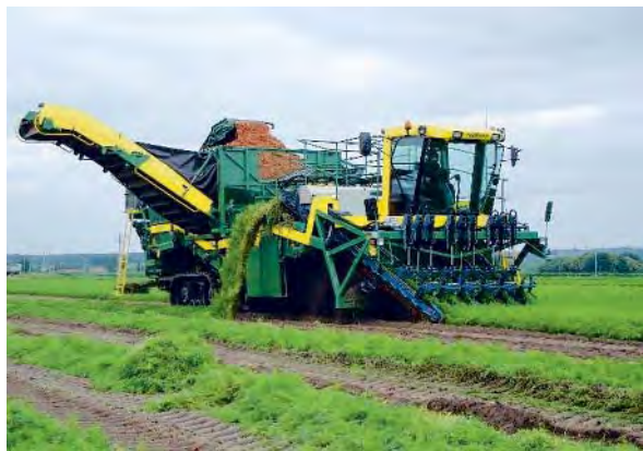
Рис. 3. Самоходный шестирядный комбайн WR 6B фирмы «PLOEGER»
