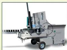
**Оборудование для приготовления торфосмесей, набивки горшков и кассет, автоматического посева и пересадки растений**
