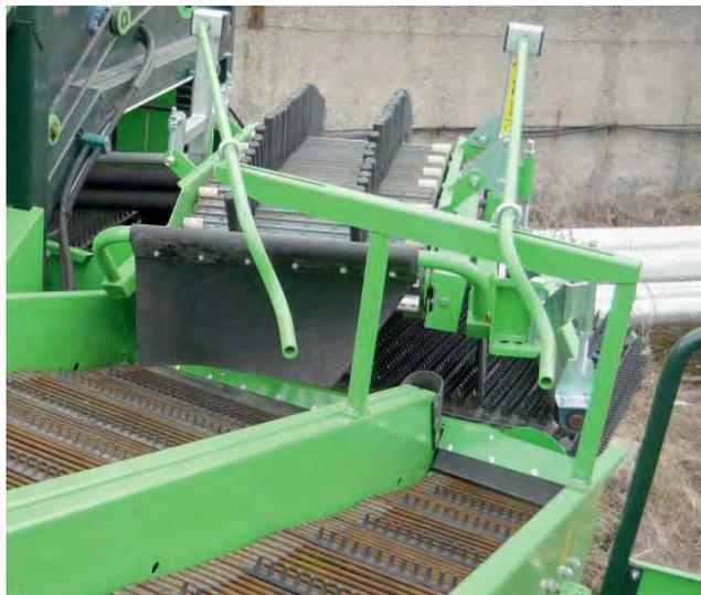
Рис. 3. Механический отделитель почвенных комков и камней от клубней картофеля роторного типа, установленный на комбайне
