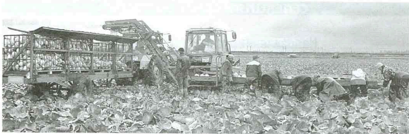
Рис. 2. Широкозахватный транспортер ТН-6 на уборке капусты с загрузкой кочанов в контейнеровоз
