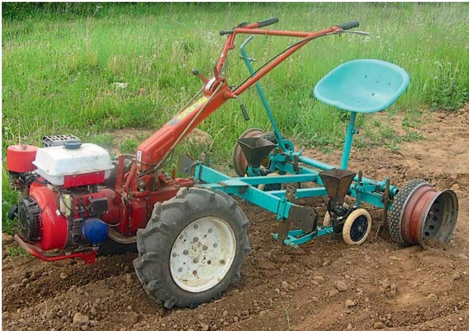
Рис. 3. Мотоблочный посевной агрегат
