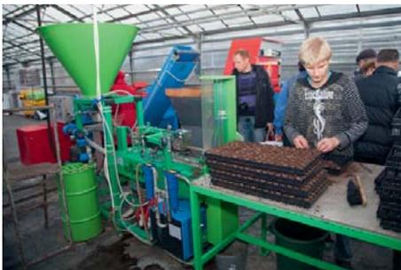
Процесс изготовления торфяных пробок
