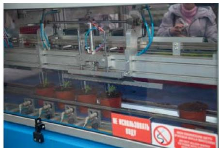
Машина с помощью роботизированных пальцев вынимает растение из кассеты и пересаживает в горшок
