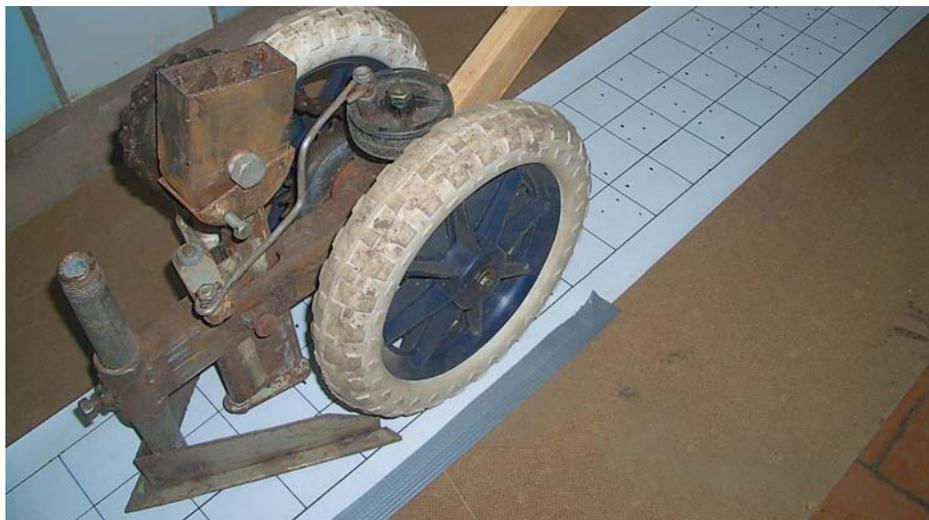
**Рис. 2.** Ручная сеялка для посева мелкосемянных культур (испытание равномерности распределения семян)
