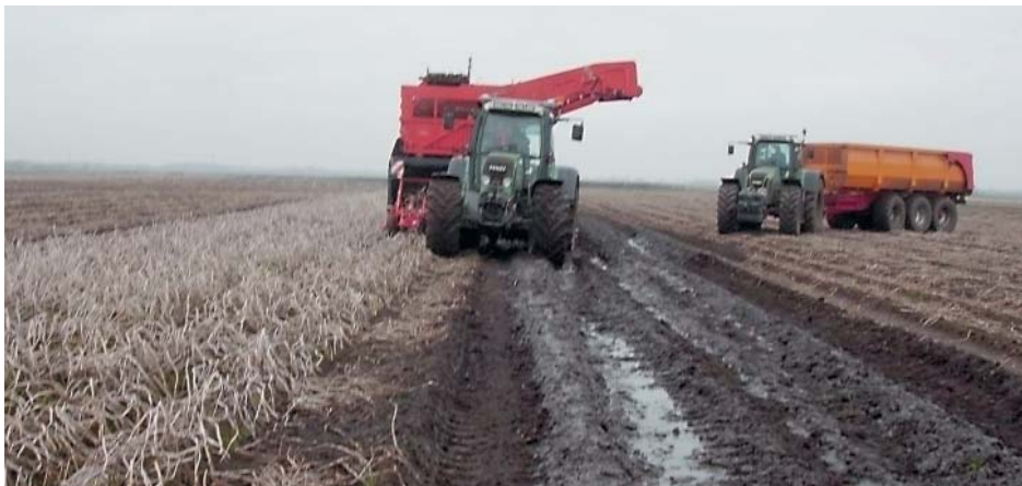
Рис. 2. Картофелеуборочный комбайн с боковым подкопом
