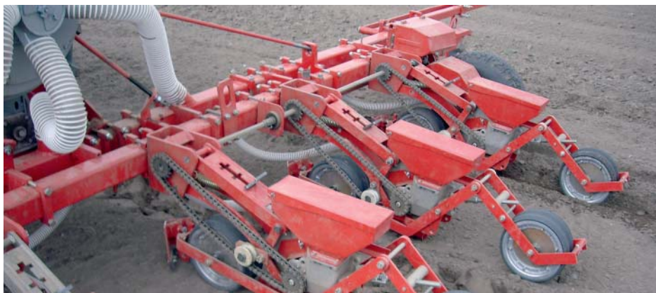
Рис. 5. Высев безрассадной капусты сеялкой СОНП-4,2
