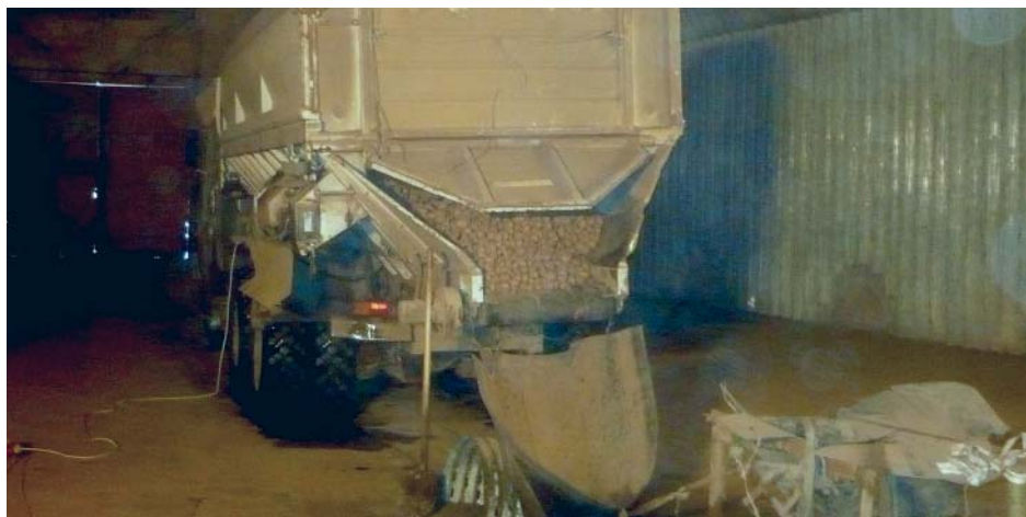
Рис. 4. Выгрузка картофеля из КрАЗа с подвижным дном в гидроканал.
