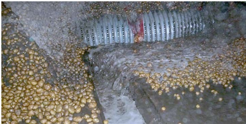
Рис. 3. Смыв клубней в гидроканал секции с помощью брендспойта.
