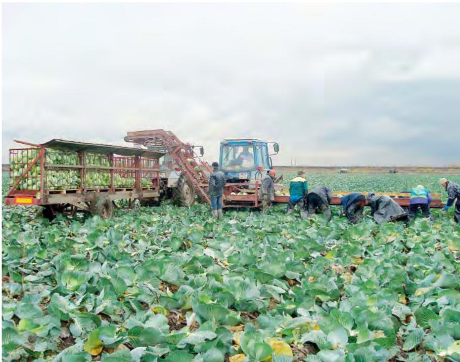
**Рис. 1.** Уборка капусты с применением транспортера ТН-6 конструкции ГНУ СЗНИИМЭСХ
