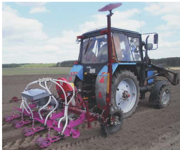
Рис. 8. Сеялка универсальная комбинированная SKO-4П в модификации пневмомеханического высева
