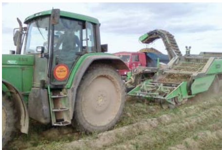
Рис. 4. Прицепной копатель-погрузчик Esprit фирмы AVR (Бельгия) с трактором John Deere 6920
