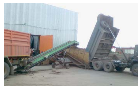
Рис. 6. Прием картофеля в хранилище по двухканальной системе: из самосвала в приемный бункер и из автомобиля с кузовом, оборудованным подвижным дном, транспортером
