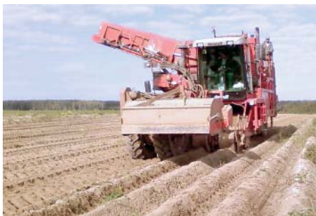
Рис. 1. Самоходный комбайн Dewulf R3060 (Бельгия) с бункером вместимостью 6 т
