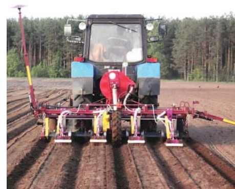
Рис. 2. Агрегат комбинированный посевной АКП-4 при формировании узкопрофильных гряд и пунктирном двухстрочном высеве семян моркови
