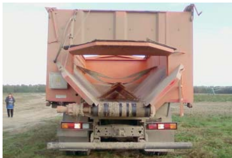
Рис. 5. Автомобиль КамАЗ «Гранд полевик» грузоподъемностью 14 т с коническим кузовом и подвижным дном
