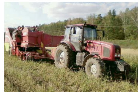
Рис. 3. Прицепной комбайн марки SE-150-60 фирмы Grütte (Германия) с бункером вместимостью 6 т с трактором «Беларусь» 20.22.3
