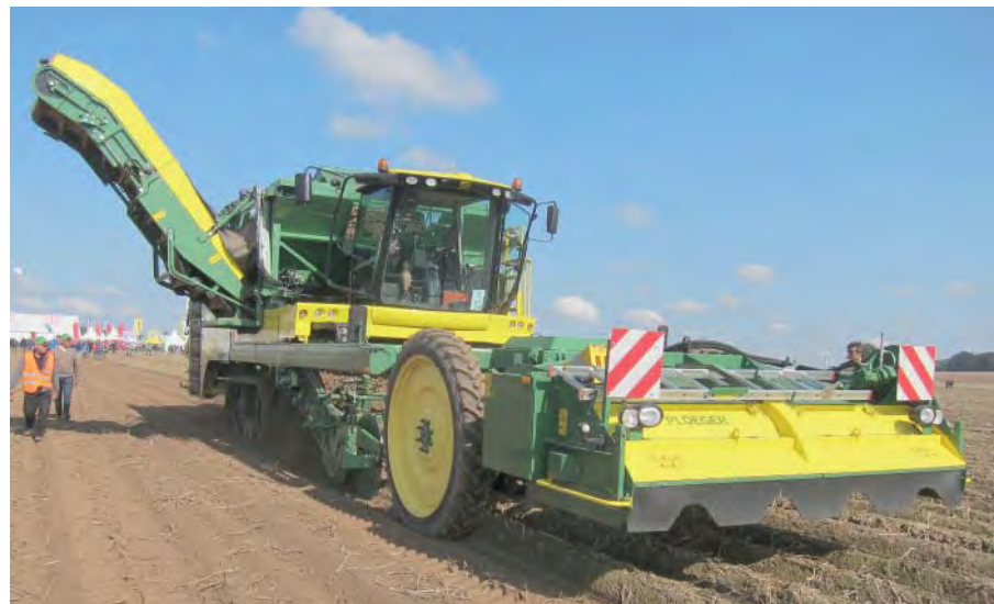
Рис. 4. Самоходный комбайн бункерного типа AR 4BX фирмы Ploeger
