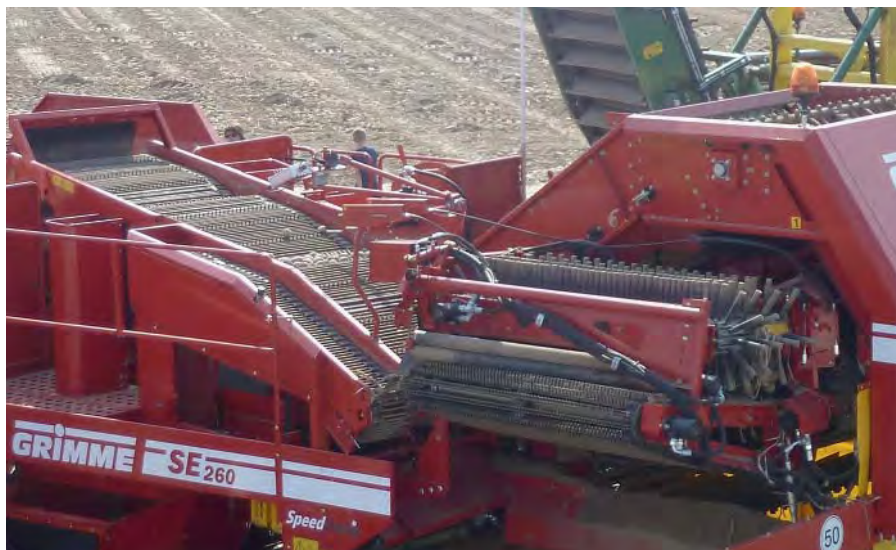
Рис. 5. Переборочный стол и роторный отделитель на комбайне SE 260 фирмы Grimme
