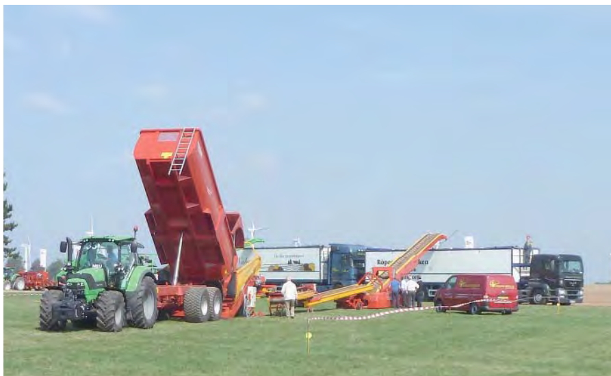
Рис. 8. Линия по послеуборочной доработке картофеля фирмы Vrijlma Hercules в работе
