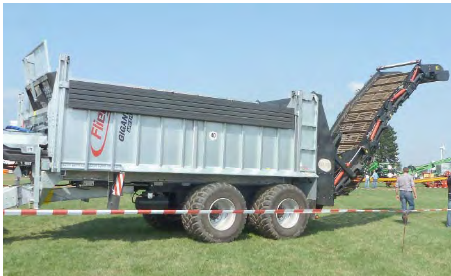
Рис. 7. Прицеп с сепаратором почвы в его задней части фирмы Fliegl Agrartechnik GmbH
