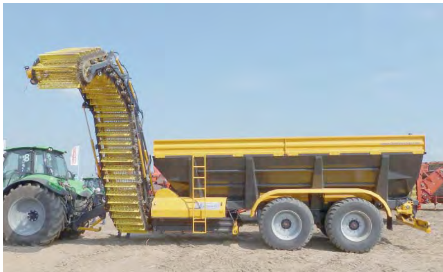
Рис. 6. Прицеп с сепаратором почвы в его передней части Brettmeister K3 фирмы Josef Brettmeister Metall- und Fahrzeugbau
