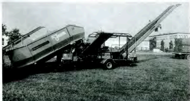
Рис. 2. Линия для послеуборочной обработки картофеля и закладки его на хранение фирмы Miedema b. v. (Нидерланды)
