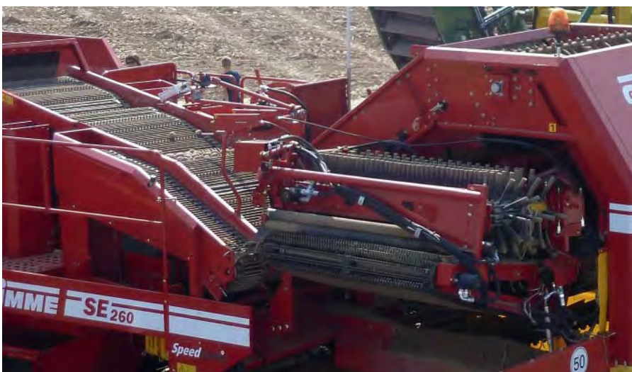
Рис. 6. Механический роторный сепаратор на комбайне SE 260
