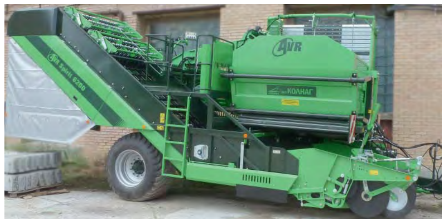
Рис. 4. Прицепной двухрядный картофелеуборочный комбайн Spirit 6200
