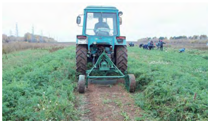
Рис. 3. Ротационное бескопирное устройство для удаления ботвы моркови на корню и сметания ее с уборной полосы
