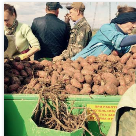
Рис. 3. Переполнение переборочного стола при уборке по схеме 2+2 и скорости движения 4 км/ч
