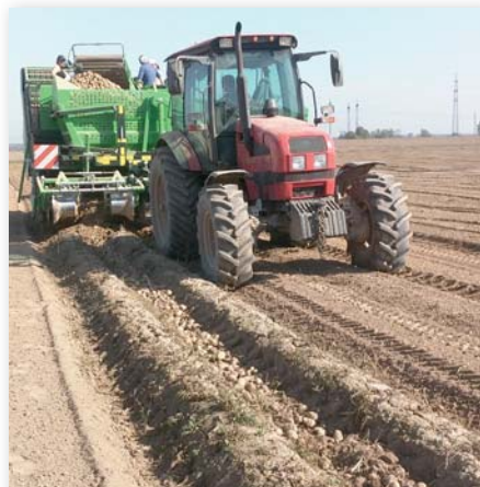
Рис. 2. Уборка картофеля по схеме 2+2 двухрядным комбайном AVR Spirit 6200 с боковым подкопом фирмы «Колнаг»
