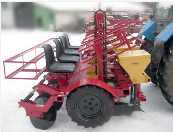
Рис. 4. Сажалка пророщенного картофеля СПК-4
