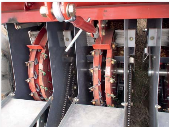
Рис. 3. Высаживающий аппарат МГЛС-6
