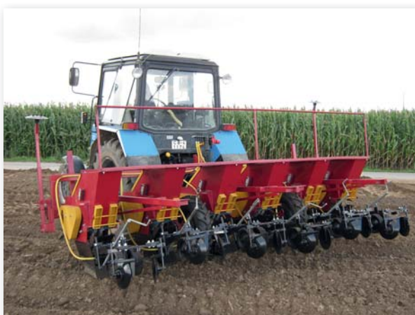
Рис. 2. Машина для посадки лука-севка МГЛС-6
