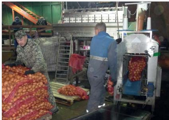
Рис. 2. Мытые клубни после системы гидротранспорта, затаренные в сетки
