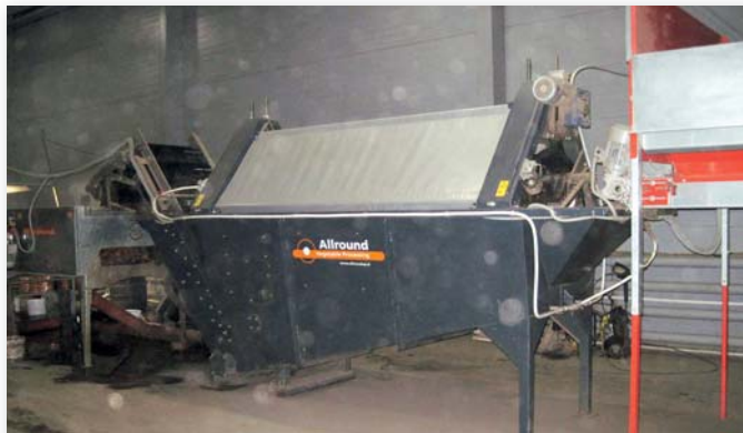
Рис. 4. Линия мойки картофеля
