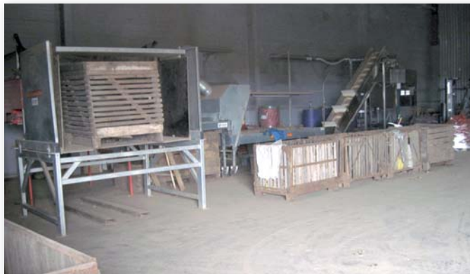
Рис. 2. Линия сухой очистки картофеля
