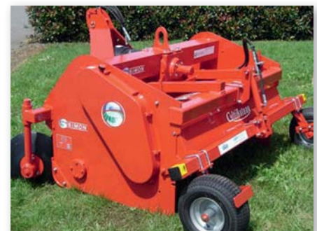
Рис. 1. Двухбарабанный фрезерный культиватор Simon Cultirateau (Франция).
