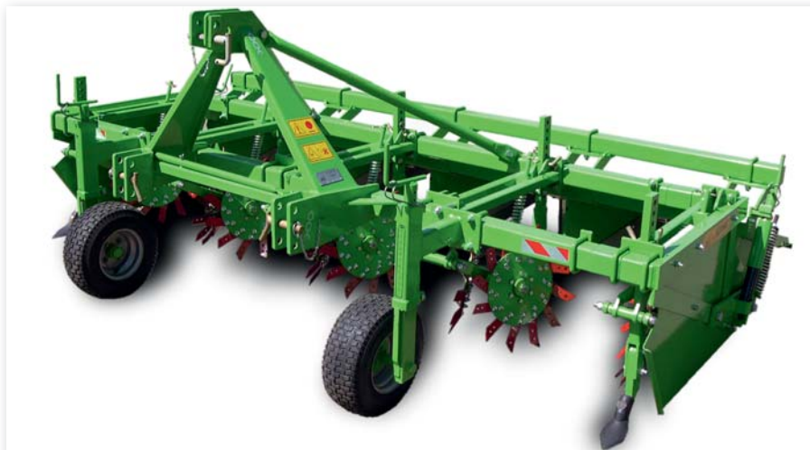
Рис. 2. Культиватор – гребнеобразователь КГП-4 (Россия)
