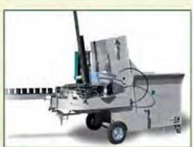
Оборудование для приготовления торфосмесей, набивки горшков и кассет, автоматического посева и пересадки растений
