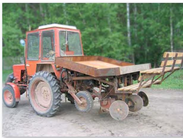
**Рис. 3.** Картофелесажалка КСУ-2А
