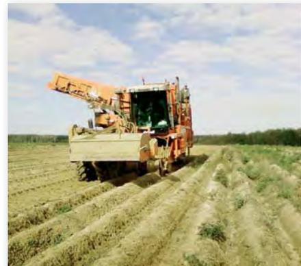
Рис. 1. Поверхность гребней после удаления ботвы комбинированным способом
