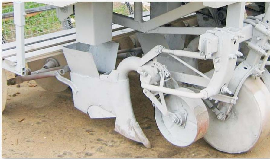
**Рис. 1.** Общий вид сошниковой группы картофелесажалки
