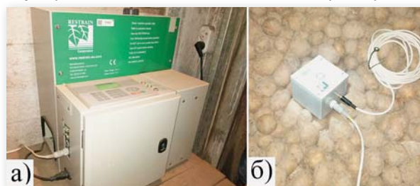
Рис. 1. Оборудование фирмы «Restrain», использованное в эксперименте: а) генератор этилена; б) датчик концентрации этилена
