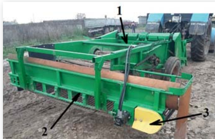
Рис. 4. Двухрядный валкоукладчик, изготовленный на базе копателя КСТ-1,4: 1 – копатель, 2 – поперечный транспортер, 3 – гидропривод
