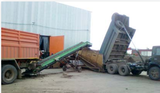
Рис. 3. Одновременная выгрузка картофеля в приемный бункер по двухканальной системе: из самосвала и из автомобиля с кузовом, оборудованного подвижным дном
