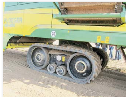
Рис. 4. Гусеничный движитель самоходного картофелеуборочного комбайна PLOEGER (Нидерланды)
