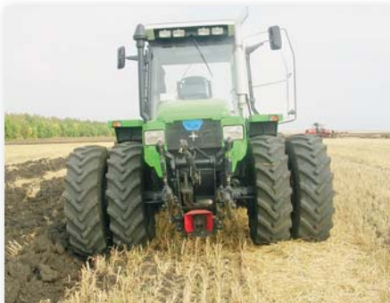
Рис. 2. Сдваивание колес на тракторе для повышения тягового усилия и снижения воздействия на почву
