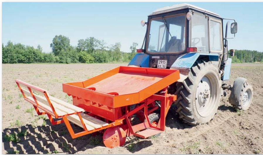
Рис. 2. Клоновая сажалка СКТ-2-П для селекции и семеноводства картофеля
