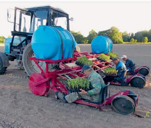
Рис. 2. Посадка рассады арбуза рассадопосадочной машиной МРП с лункообразующей системой и локально-дозированной подачей воды
