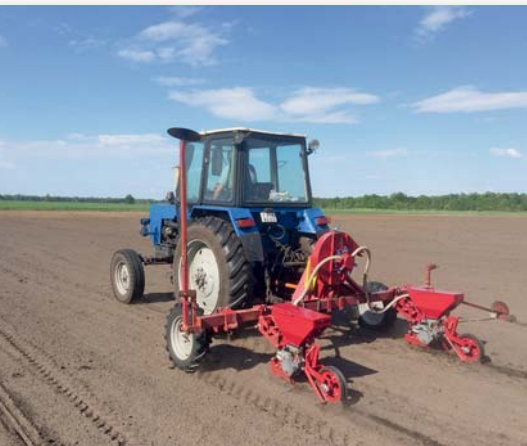
Рис. 1. Посев семян арбуза сеялкой СТВ-2
