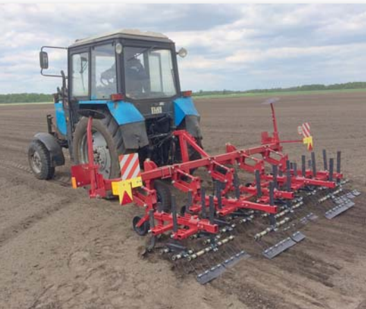
Рис. 3. Предпосевная обработка почвы агрегатом универсальным АУ-М 2
