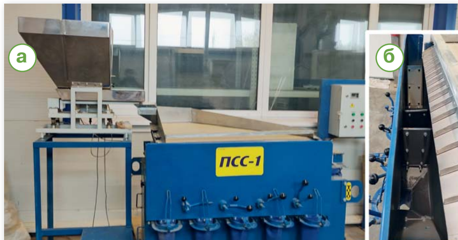
Пневмосортировальный стол ПСС-1: а-общий вид; б-разделительный козырек с подвижными заслонками
