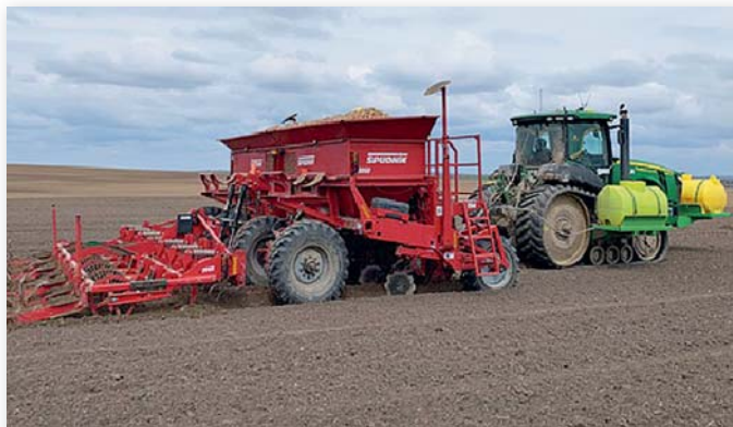
Рис. 6. Комбинированный картофелепосадочный агрегат для выполнения полного цикла весенне-полевых работ
