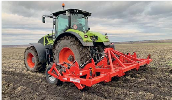
Рис. 5. Осенняя нарезка гребней пропашным культиватором-глубокорыхлителем
