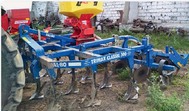
Рис. 3. Модуль для посева сидератов, установленный на культиваторе
