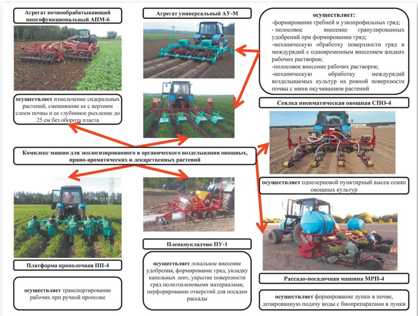
Рис. 1. Комплекс машин для экологизированного и органического возделывания овощных, пряно-ароматических и лекарственных растений
